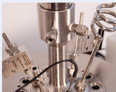
Cover plate with 6 openings Deckelplatte mit 6 Öffnungen
