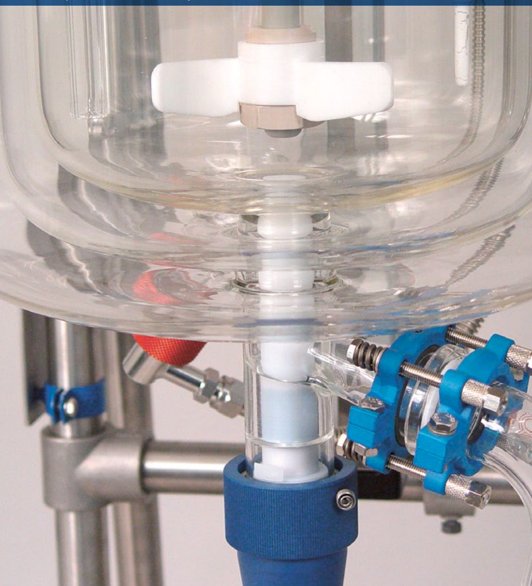
PFA coated stirrer shaft PFA-beschichtete Rührwelle
