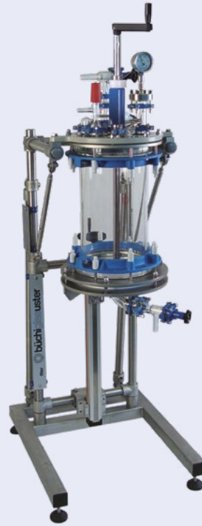
Nutsche filter with hand stirrer Filternutsche mit Handrührer
