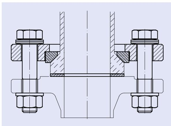
«büchiglas»-Planschliff-Verbindung DN 15-200
