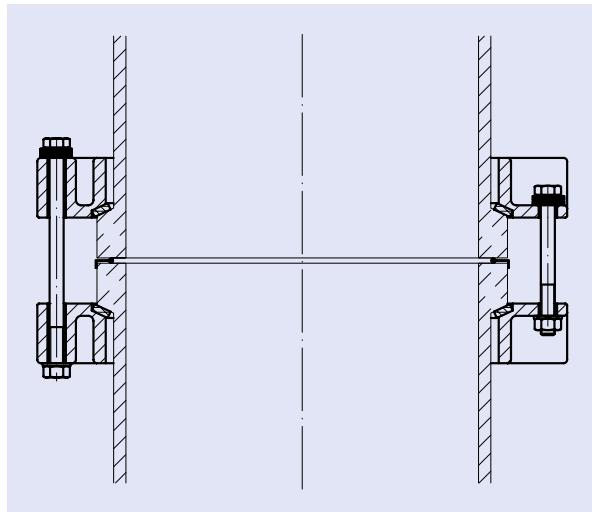
KF-Planschliff-Verbindung DN 200-600 für Apparate- und Kolonnenbau
