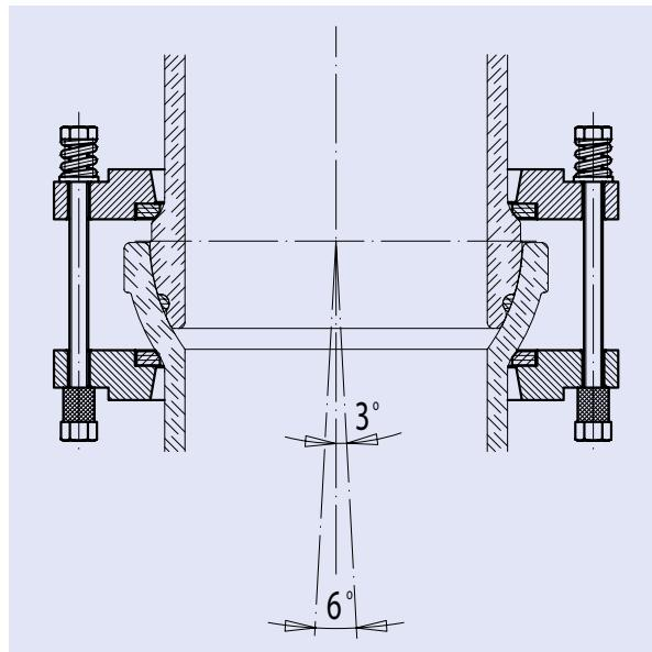
büchiflex-Rohrverbindung DN 15-150 für den Rohrleitungs- und Apparatebau
